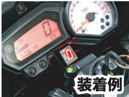
接続ハーネスはECUとメーターハーネスにエレクトロタップで接続します。
