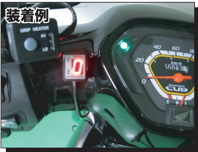
専用ハーネスは、メーター裏インジケータランプ配線と右レッグシールド内の点火コイルの桃/青線です。
