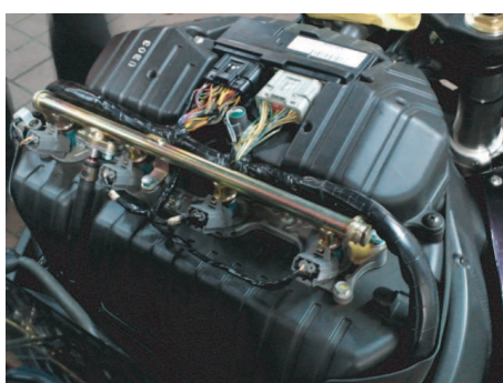
配線の接続先は、ECUカプラーおよびメーターカプラーの配線。
