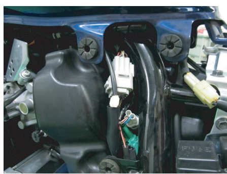
配線の接続先は、ヘッドライトケース内の配線およびサイドカバー内のカブラー。
