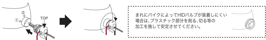
HIDバルブのTOPの位置をヘッドライトの▽①に合わせて慎重に差し込み、右に回しTOPの位置が▽②になるように確実に固定してください。
