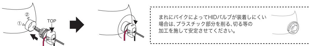
HIDバルブのTOPの位置をヘッドライトの▽①に合わせて慎重に差し込み、右に回しTOPの位置が▽②になるように確実に固定してください。
