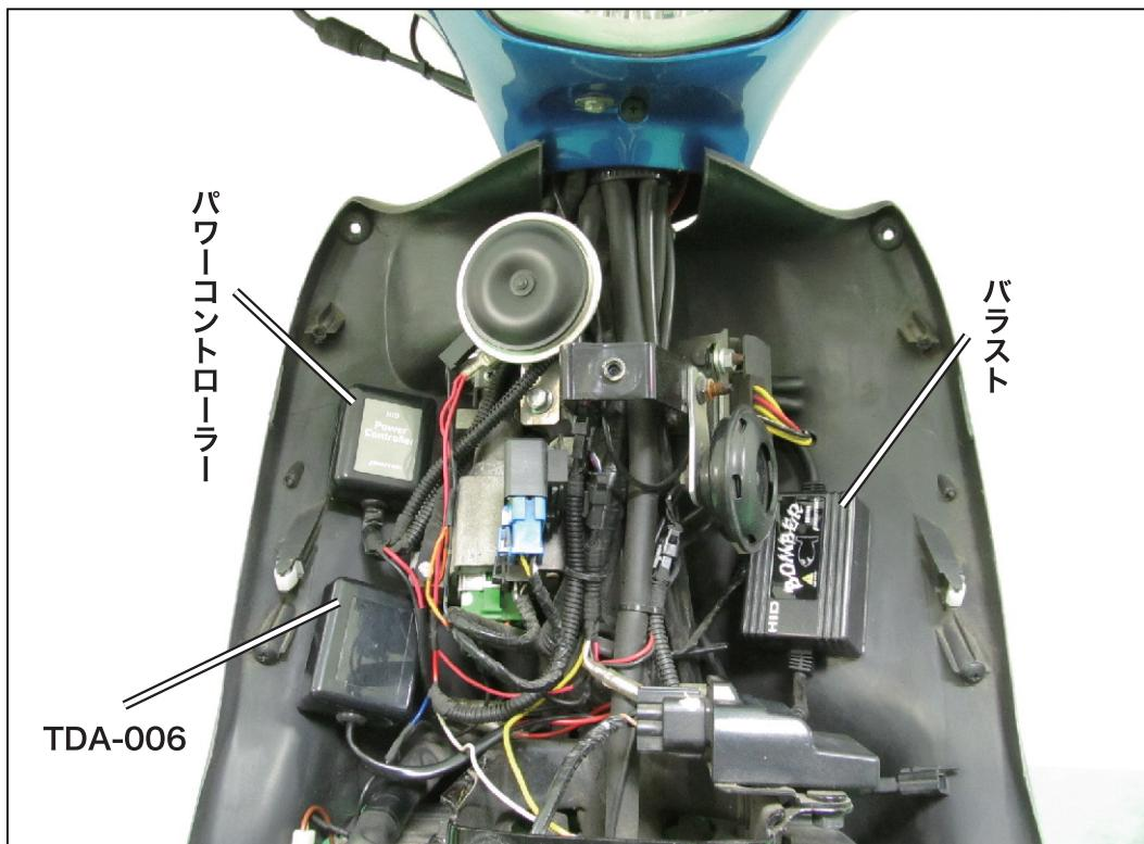
①バラスト、パワーコントローラー、TDA-006を両面テープで固定します。
