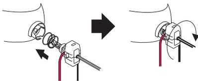
まれにバイクによってHIDバルブが装着しにくい場合は、プラスチック部分を削る、切る等の加工を施して安定させてください。
