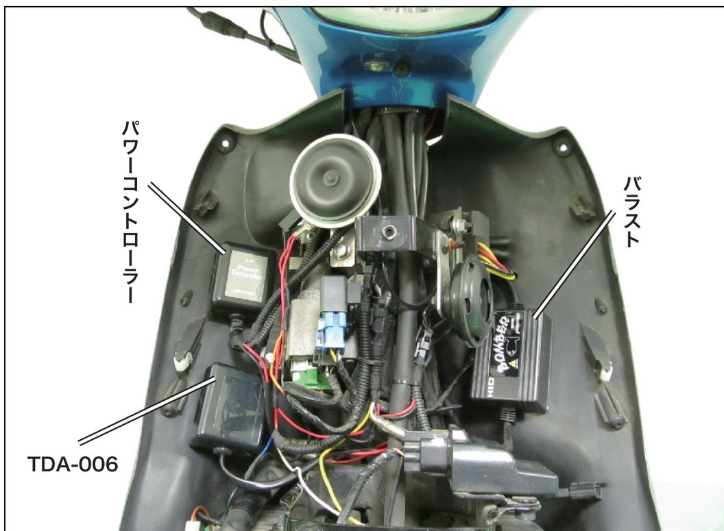
バラスト、パワーコントローラー、TDA-006を両面テープで固定します。
