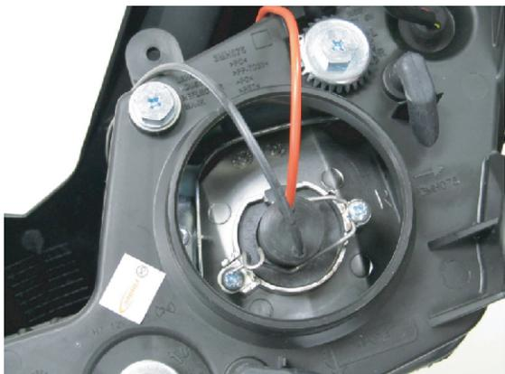
⑥ヘッドライトハーネスとバラストを接続します。HIDバルブとバラストの高圧コードのカプラーを接続します。
