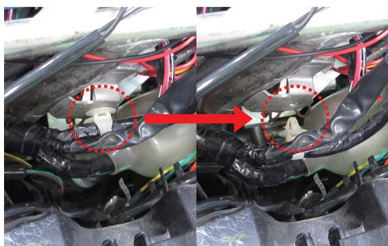
①下準備として、白いプラスチック部品を外しバラストを取付けるスペースを確保しておきます。
