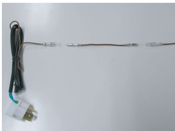
①ヘッドライト接続ハーネス（部品表⑤）の両端がオスギボシの配線を抜きます。
