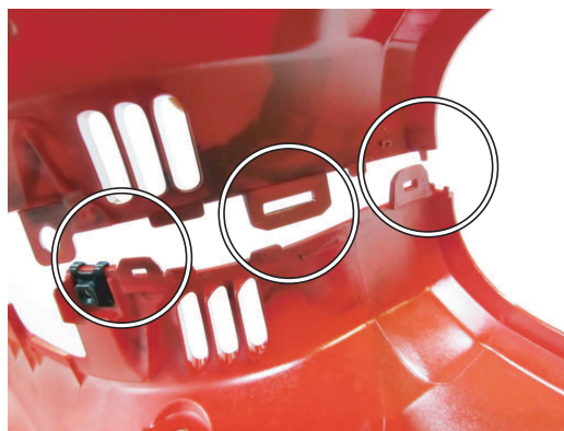
②レッグシールドは左右連結しているツメが3か所あります。分割時に折らない様にご注意ください。
