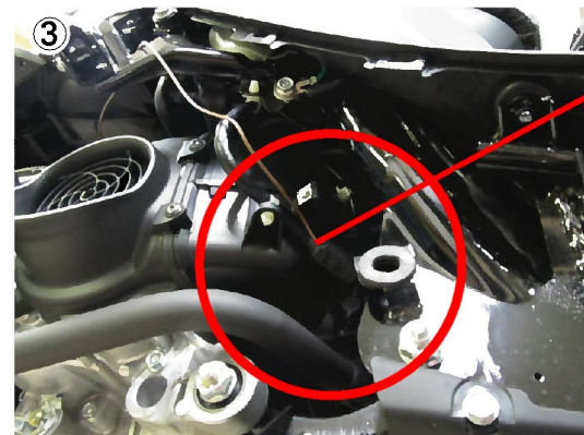
プラグコードに茶色線に沿わせて、クランプコアで挟んで固定します。
