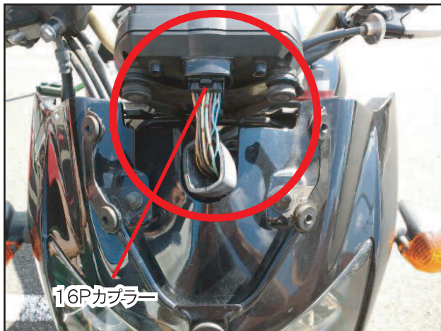
赤丸のボルトを外してスクリーンを外します。
