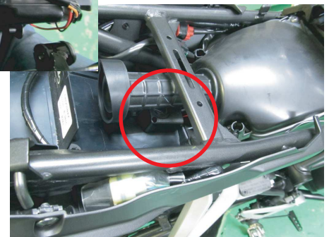
シート下のサイレン取付け位置
