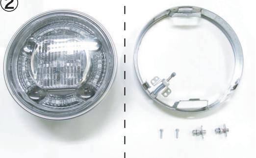
③純正部品レンズ(33120-MAX-003)をリムに取り付けます。②で外したネジを使って元と同じ様に組付けます。
