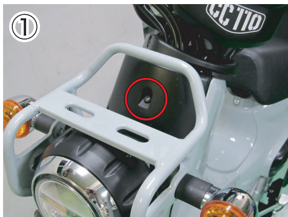
①赤丸で示したネジ1本を外してフロントカバー(黒)を取り外します。
