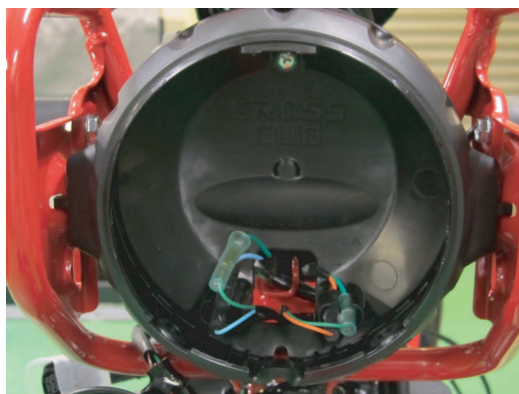
⑥ヘッドライトを外します。ハーネスカプラーはキーシリンダー下にあります。
