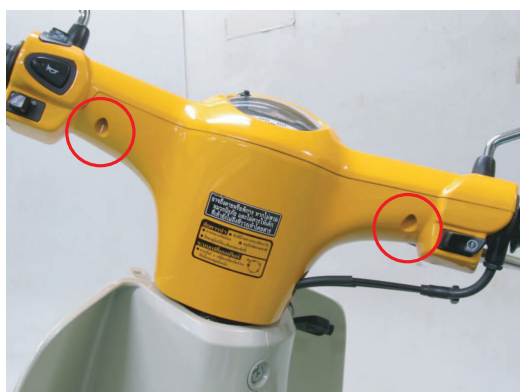
②○で囲った部分の2本のネジを外します。
