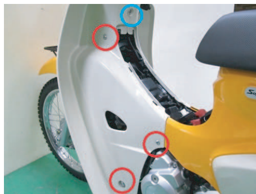
⑤○で囲った部分のボルトを外します。 左右レッグシールドを外します。
