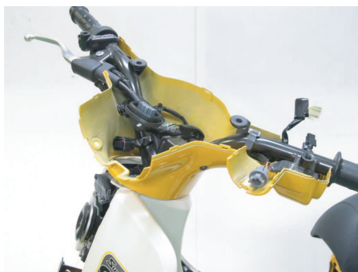
④ヘッドライト、左右ウインカーレンズ、 左右バックミラーを外します。 ハンドル周りのカバーを上下に分割します。
