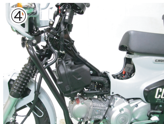
④ ①～③の外装カバーが全て取り外された状態
