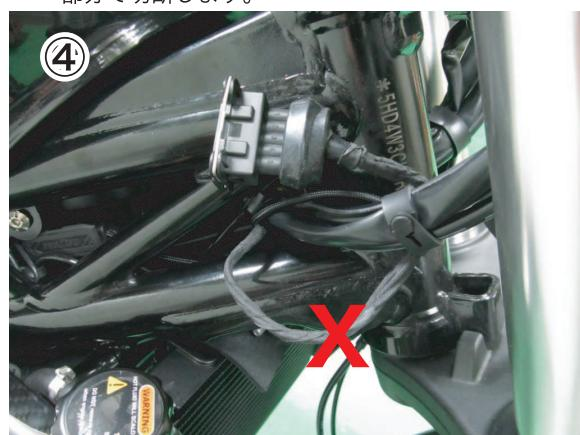
⑤ ④で切断した車両側ヘッドライトハーネスに部品表⑧の110型端子を圧着しコネクターを取り付けます。
