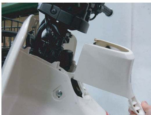
③キーシリンダー周りのカバーを外します。 車両後方に引っ張れば取り外す事が出来ます。
