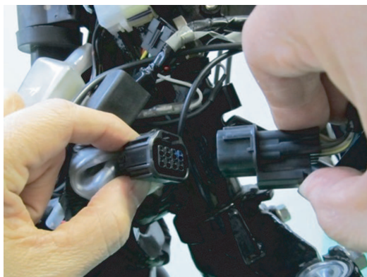
⑤キーシリンダー下にあるヘッドライトハーネス の防水黒8Pカプラーを分割しておきます。
