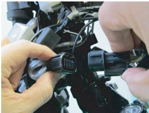
⑤キーシリンダー下にあるヘッドライトハーネス の防水黒8Pカブラーを分割しておきます。
