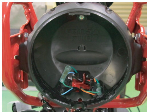
⑥ヘッドライトを外します。ハーネスカプラーはキーシリンダー下にあります。
