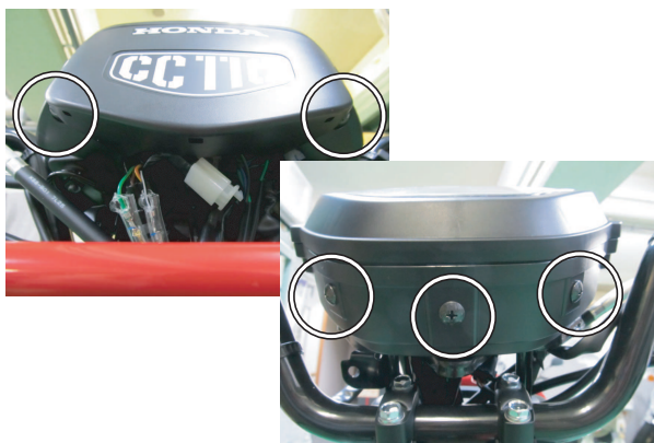
④画像の○で示したネジを外して上部メーターカバーを取り外します。
