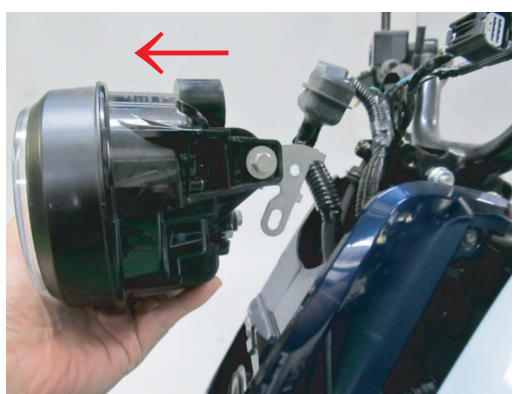
④手前にスライドさせてヘッドライトを 取り外します。
