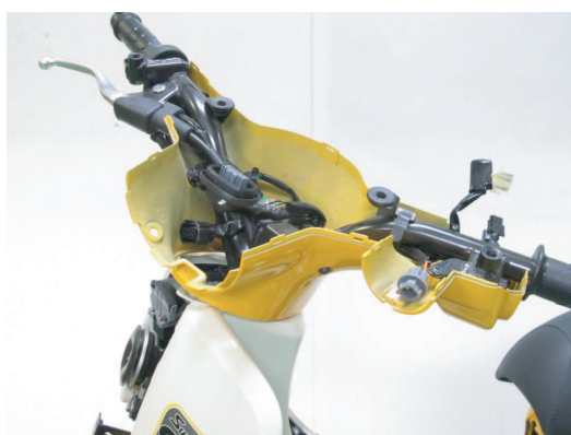
④ヘッドライト、左右ウインカーレンズ、 左右バックミラーを外します。 ハンドル周りのカバーを上下に分割します。
