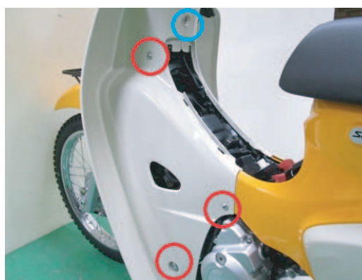
⑤○で囲った部分のボルトを外します。 左右レッグシールドを外します。
