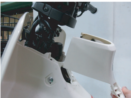
③キーシリンダー周りのカバーを外します。 車両後方に引っ張れば取り外す事が出来ます。
