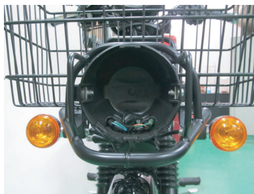
⑥ヘッドライトレンズ下の2本のネジを外して ヘッドライトを外します。
