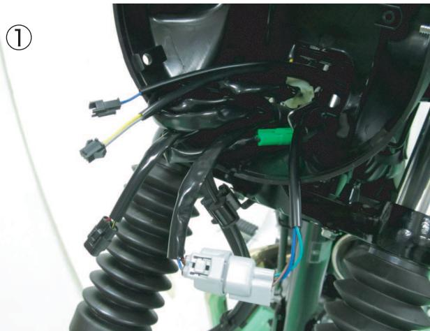
① コントローラーユニットのハーネス（灰3P、黒3P、黒2P）をヘッドライトケース内に引き込み、車両側のノーマルLEDヘッドライトに接続されていた灰3Pカプラーと、接続します。
