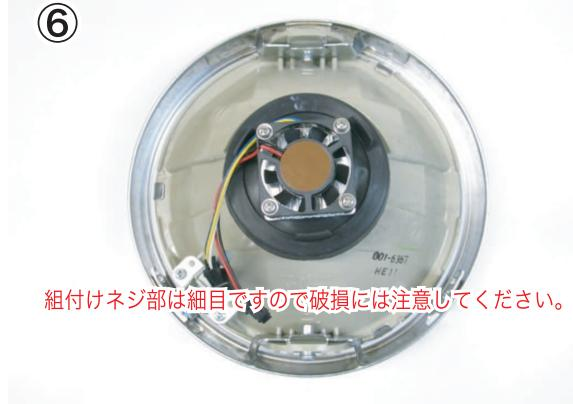
組付けネジ部は細目ですので破損には注意してください。
