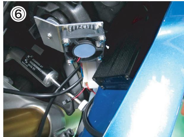
本取説表面の配線図に従って各力プラーを接続してください。配線は結束バンドなどで確実に固定してください。
