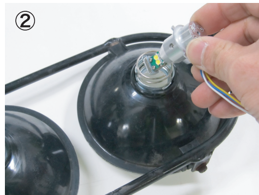
②ノーマルバルブを外してスプリングを入れLEDバルブを取付けます。
