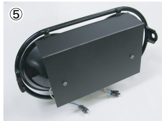
⑤放熱用プレート(LEDバルブ)にネジ留めします。 ※3x8ナベネジと歯付きワッシャーをします。
