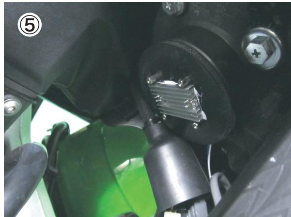
⑥ 防水冷却ファンをネジ留めします。ファンはシール面を外側に向けて取付けてください。
