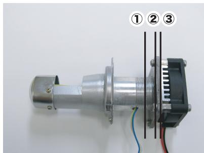
本製品は効率の良い放熱効果を得る為に、メーカー工場より出荷時に左の画像の①～③で示したLEDバルブの各パーツの接合部に、導熱シリコングリスが塗布されております。
