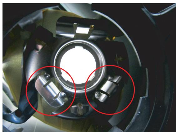
※LEDバルブはUPの刻印を上に向けて、LEDチップが3時と9時を向く様に取付けてください。
