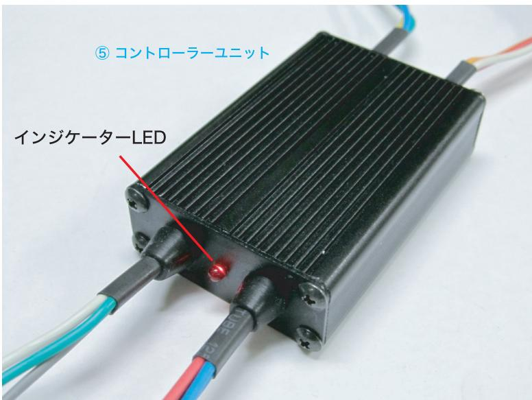
コントローラーユニットに電気が流れるとインジケーターLEDランプが点灯します。
