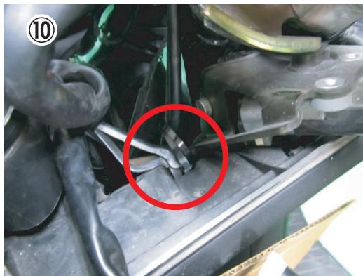
⑪ ⑫ ハンドルを左右に切ってステアリングやケーブル類がヒートシンクに当たらない位置でM3X15ネジを締め込みます。
