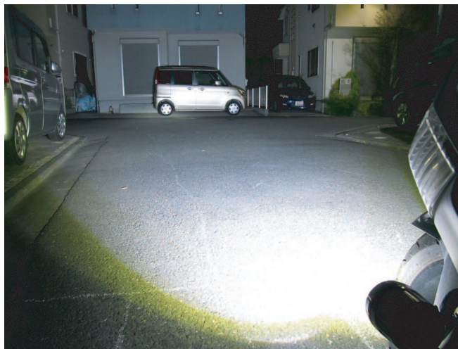
エンジン回転約2,000rpm以上の走行中はフルパワー点灯
