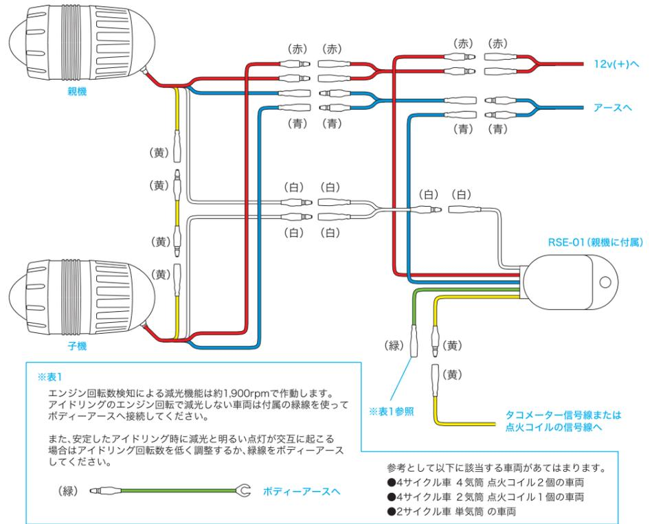
**警告** 本製品をお取付けになる場合は、必ずバッテリーのマイナス端子を外した状態で取付け作業を行ってください。
