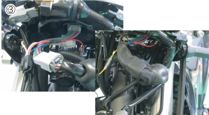
**※12V(+)出力サービス端子は、弊社[盗難警報機CS-550M]の接続を始め、アクセサリー電源として多目的に活用頂けます。**
