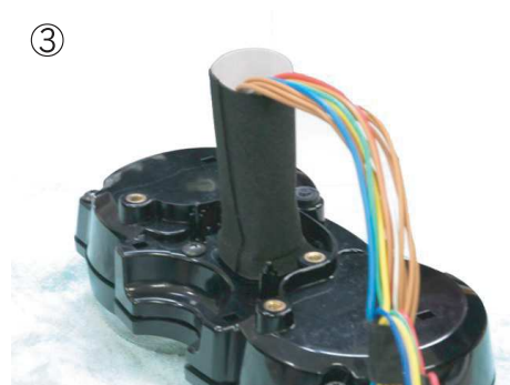
③防水シートを貼り合わせます。
