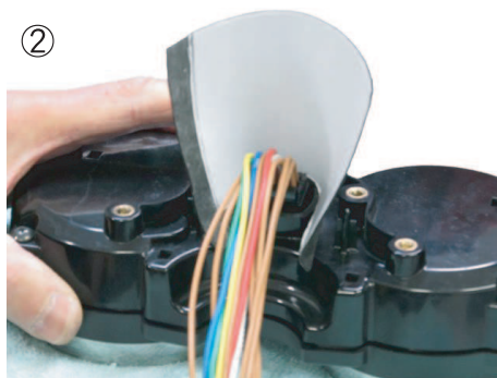
②防水シートを巻きつけます。
