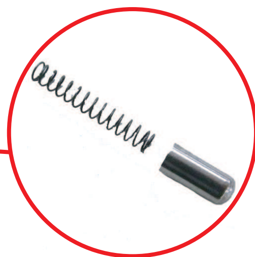
⑤赤丸で囲った部分のピンとスプリングを取り外し、スプリングを数ミリ伸ばしテンションを強くする事で接触が良くなり表示不良の改善になります。
