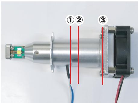
本製品は効率の良い放熱効果を得る為に、工場より出荷時に左の画像の①～③で示したLEDバルブの各パーツの接合部に、導熱グリスが塗布されております。
