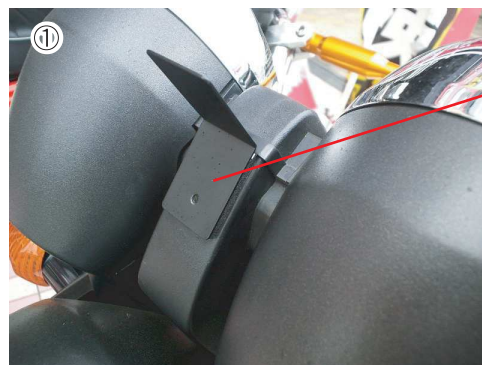
専用メータステー角度を曲げて調整してください。
